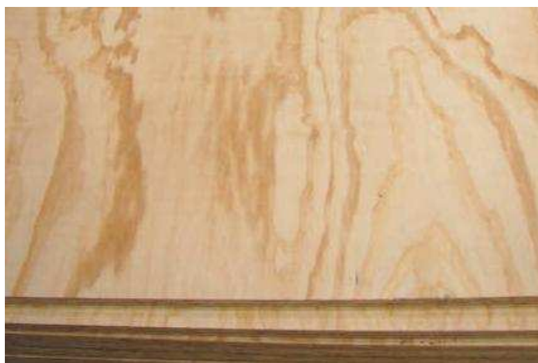
Рис. 4. Текстура лущеного шпона
