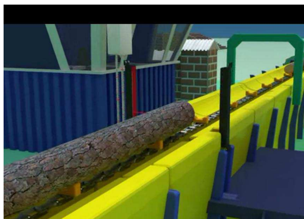
Рис. 18. Линия сортировки бревен с одноплоскостным сканером
